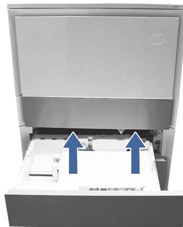
7. Verificare che le guide della larghezza e della lunghezza del vassoio siano impostate sul formato corretto della carta da inserire nel vassoio e che il vassoio non sia riempito al di sopra del segno di riempimento (sotto i 3 triangoli sulla guida posteriore).
