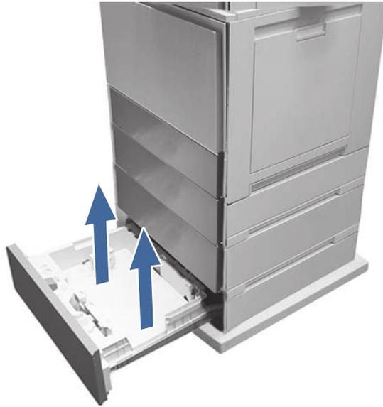
9. Verificare che le guide della larghezza e della lunghezza del vassoio siano impostate sul formato corretto della carta da inserire nel vassoio e che il vassoio non sia riempito al di sopra del segno di riempimento (sotto i 3 triangoli sulla guida posteriore).
