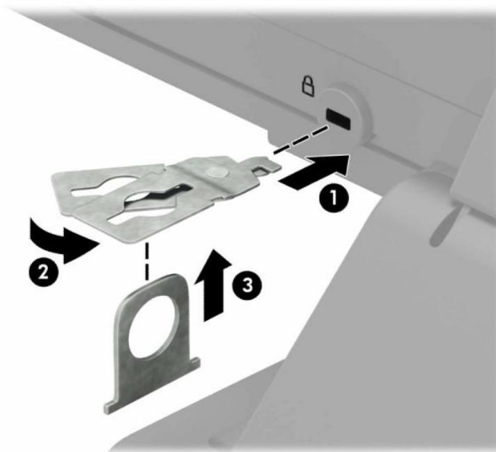
5. Far scorrere il cavo di sicurezza attraverso la guida di sicurezza installata sul monitor.
