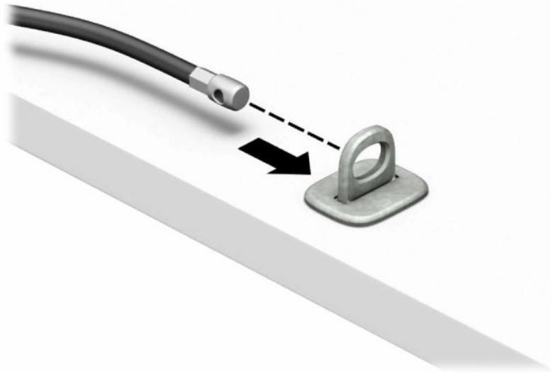
4. Smontare le due forbici di blocco del monitor e inserire il dispositivo di blocco nello slot di sicurezza sul retro del monitor (1), richiudere le forbici per fissare il blocco in posizione (2), quindi far scorrere la guida del cavo attraverso il centro del blocco del monitor (3).
