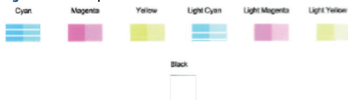
Figura 9-2 Esempi di blocchi di colore con difetti
