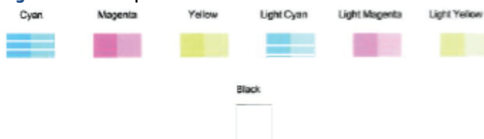
Figura 9-2 Esempi di blocchi di colore con difetti
