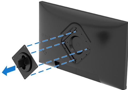
3. Per fissare la testa del monitor a un braccio snodabile o ad altri dispositivi di montaggio, allineare la piastra di montaggio sul braccio snodabile con i fori per viti sul retro della testa del monitor (1).
