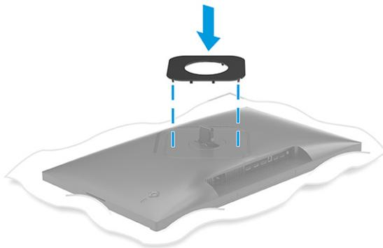
2. Allineare il supporto con la base (1), fissare la levetta (2), quindi serrare la vite (3).
