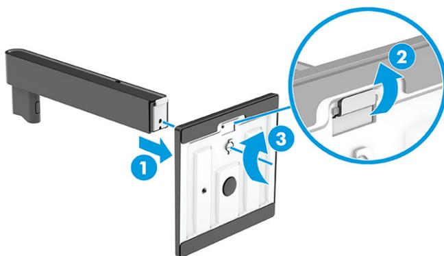
3. Fissare il supporto sul retro della testa del monitor.
