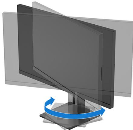
4. È possibile ruotare la testa del monitor dall'orientamento di visualizzazione orizzontale a quello verticale per adattarla all'applicazione in uso (non disponibile sui modelli curvi).
