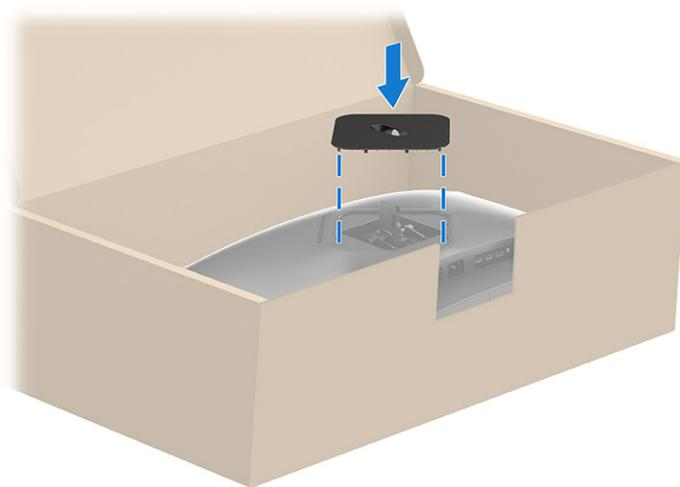
2. Allineare la base con il supporto (1), fissare la levetta (2), quindi serrare la vite (3).
