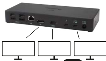
3 monitoren tegelijkertijd aangesloten 1x DisplayPort 1x HDMI 1x Thunderbolt 3 resolutie max. 4K 4096x2160@30Hz
