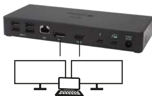
2 monitory připojeny zároveň 1x DisplayPort a 1x HDMI rozlišení max. 4K 4096x2160@60Hz
