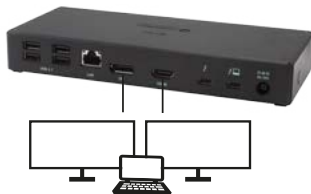
2 monitory połączone jednocześnie 1x DisplayPort i 1x HDMI, rozdzielczość do 4K 4096x2160@60Hz
