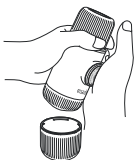
15 A pressão deprimeiros 8 cursos é construída. Bombeie lentamente até que todo o café saia.
