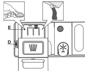
1. Per il dosaggio corretto del detersivo fare riferimento ai dati sopra riportati. La vaschetta **E** contiene indicatori di livello per facilitare il dosaggio del detersivo.
