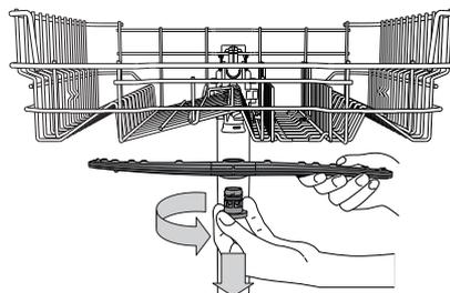
Per smontare il braccio aspersore superiore, ruotare l'anello di bloccaggio in plastica in senso antiorario. Il rimontaggio del braccio aspersore deve avvenire in modo che il lato con il maggior numero di fori sia rivolto verso l'alto.
