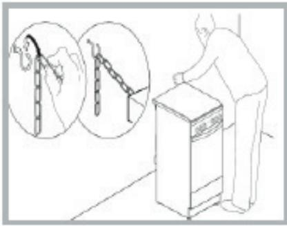
Al fine di evitare che l'apparecchio si ribalti accidentalmente, ad esempio nel caso in cui un bambino si arrampichi sulla porta del forno, È **INDISPENSABILE** **INSTALLARE** la catena di sicurezza fornita in dotazione!
