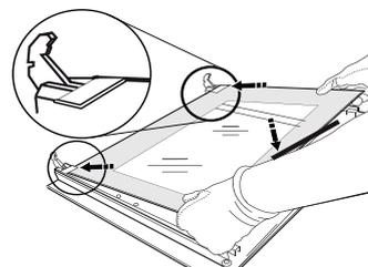
4. Instale novamente a extremidade superior: irá ouvir um clique, indicando que está bem posicionado. Certifique-se de que a vedação está segura antes de montar novamente a porta.
