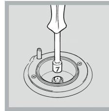
Sostituzione degli ugelli per i bruciatori del piano di cottura:
