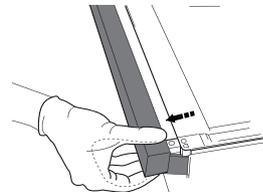
2. Sollevare e prendere saldamente il vetro interno con due mani, rimuoverlo e appoggiarlo su un piano morbido prima di eseguire la pulizia.
