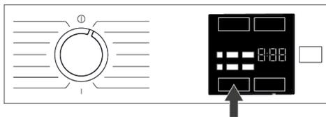
Quando si seleziona un nuovo programma, la velocità di centrifuga consigliata del programma selezionato è visualizzata sull'indicatore velocità di centrifuga. È possibile tale valore consigliato non sia la velocità di centrifuga massima selezionabile per il programma corrente.
