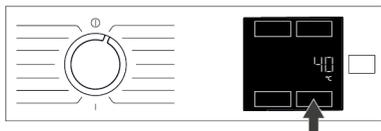
Ogni volta che viene selezionato un nuovo programma, dopo un certo periodo di tempo, sull'indicatore della temperatura appare la temperatura consigliata. È possibile che la temperatura consigliata non sia il valore massimo selezionabile per il programma corrente.
