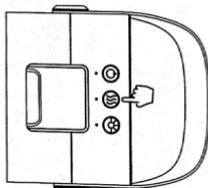
Nota: Assicurarsi che ci sia acqua nel serbatoio quando si preme il pulsante "Nebulizzazione". In caso vi sia mancanza dell'acqua nel serbatoio, si consiglia di aggiungere l'acqua o interrompere la funzione di umidificazione in tempo, altrimenti l'unità potrebbe danneggiarsi.
