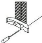
Prima di utilizzare il prodotto montare i piedini (forniti nel cartone). Per farlo, utilizzare le 4 viti autofilettanti in dotazione, avendo cura di posizionarle correttamente nelle estremità inferiori della parte laterale del dispositivo.
