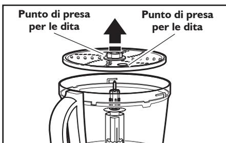
**4** Se si sta utilizzando un disco, è necessario rimuoverlo. Tenendo il disco nei due punti di presa per le dita, sollevarlo andando dritto verso l'alto.
