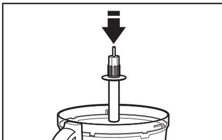
**2** Posizionare l'adattatore nell'albero di trasmissione.
