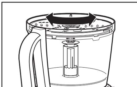
2 Ruotare leggermente il disco fino a portarlo nella posizione corretta sull'adattatore.
