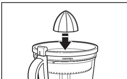
**4** Posizionare il cono all'interno della vaschetta filtro, collegandolo all'adattatore. Potrebbe essere necessario ruotare il cono finché non arriva nella posizione corretta.
