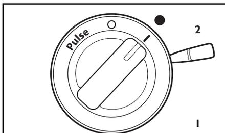
**1** Per accendere, posizionare la leva della velocità su "2" (alta) o "1" (bassa) e girare la manopola su "I" (ON).
