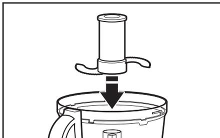
**1** Posizionare la lama sull'albero di trasmissione.
