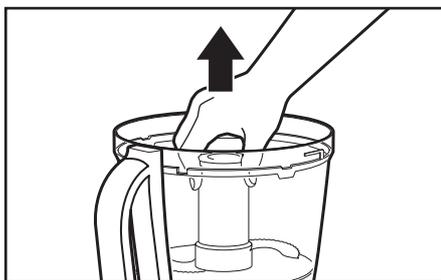
**6** Se si sta utilizzando una lama, rimuoverla tenendola ben stretta e tirando verso l'alto.
