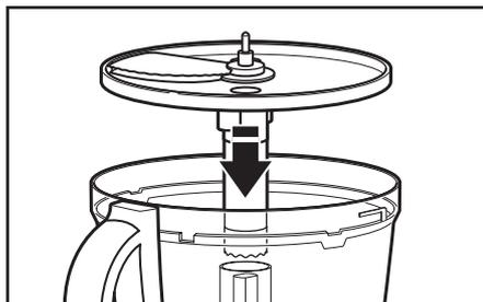
**1** Posizionare il disco nell'albero di trasmissione.
