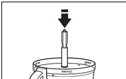
**1** Posizionare l'adattatore per spremiagrumi nell'albero di trasmissione.
