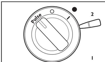
**3** Per utilizzare la funzione Pulse, posizionare la leva della velocità su "2" (alta), quindi portare la manopola su PULSE per avviare la lavorazione; la manopola tornerà automaticamente su "O" (OFF) per interrompere la lavorazione. Il comando Pulse consente di controllare con estrema precisione la durata e la frequenza della procedura di lavorazione.
