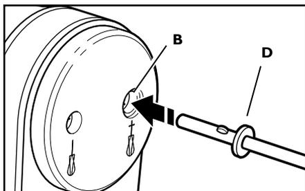
**2** Inserire l'albero dell'accessorio con collare (D) nel foro più largo (B) dello sbattitore. Allineare le flange dell'albero con le fessure all'interno del foro. Spingere per bloccare in posizione.
