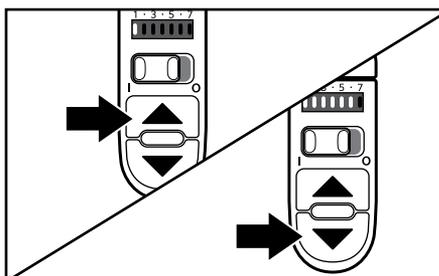
**3** Per aumentare la velocità fino al livello desiderato, premere il pulsante freccia su. Se necessario, diminuire la velocità con il pulsante freccia giù. Per ulteriori informazioni, consultare la sezione "Guida al controllo della velocità".
