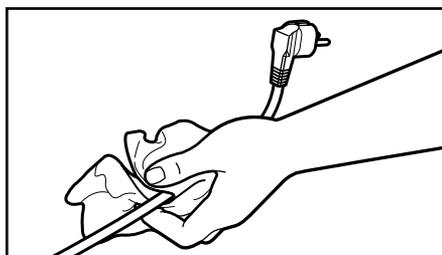
**1** Scollegare sempre lo sbattitore prima di pulirlo. Pulire il cavo di alimentazione e la fascetta con un panno umido. Asciugare con un panno morbido.
