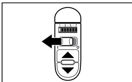
**2** Portare l'interruttore di accensione nella posizione "I" (On). Il motore si avvia automaticamente alla velocità 1 (l'indicatore di velocità "1" si illumina).
