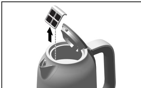
2. Pulire con acqua calda e una spazzola o un panno per rimuovere i depositi e sostituire il filtro facendolo scorrere nella fessura dietro il beccuccio.
