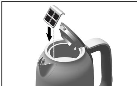
**Rimozione del filtro:** aprire il coperchio. Afferrare la parte superiore del filtro, dietro il beccuccio, e tirare per rimuoverlo.
