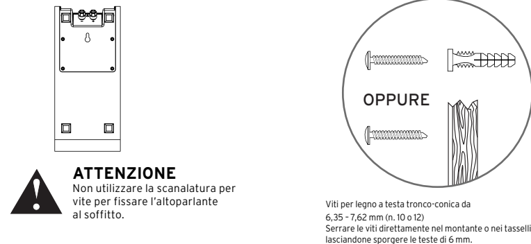
FIGURA 4 FISSAGGIO A PARETE DEGLI ALTOPARLANTI SURROUND
