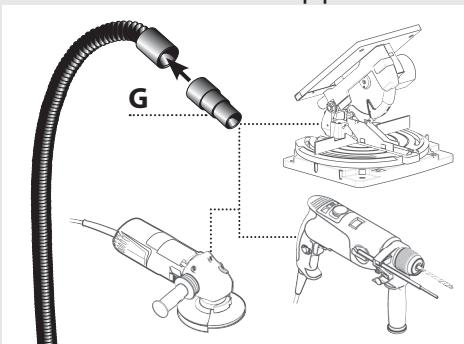
**IT** Per attivare la funzione presa elettrotensile è necessario posizionare l'interruttore **D** su (I)ON e l'interruttore **DD** su (0)OFF. Con utensile inserito, l'aspiratore si accende all'accensione dell'utensile. Il tubo di aspirazione collegato aspira direttamente polvere, trucioli.
