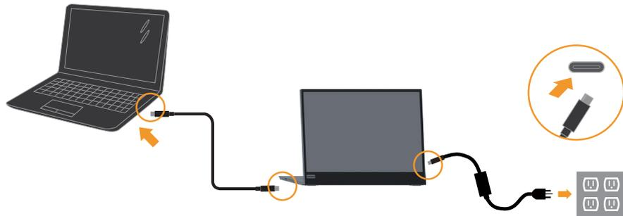
2) Collegare l'alimentatore di tipo C sul lato sinistro o destro di L15 e collegare L15 al cellulare con un cavo USB-C.
