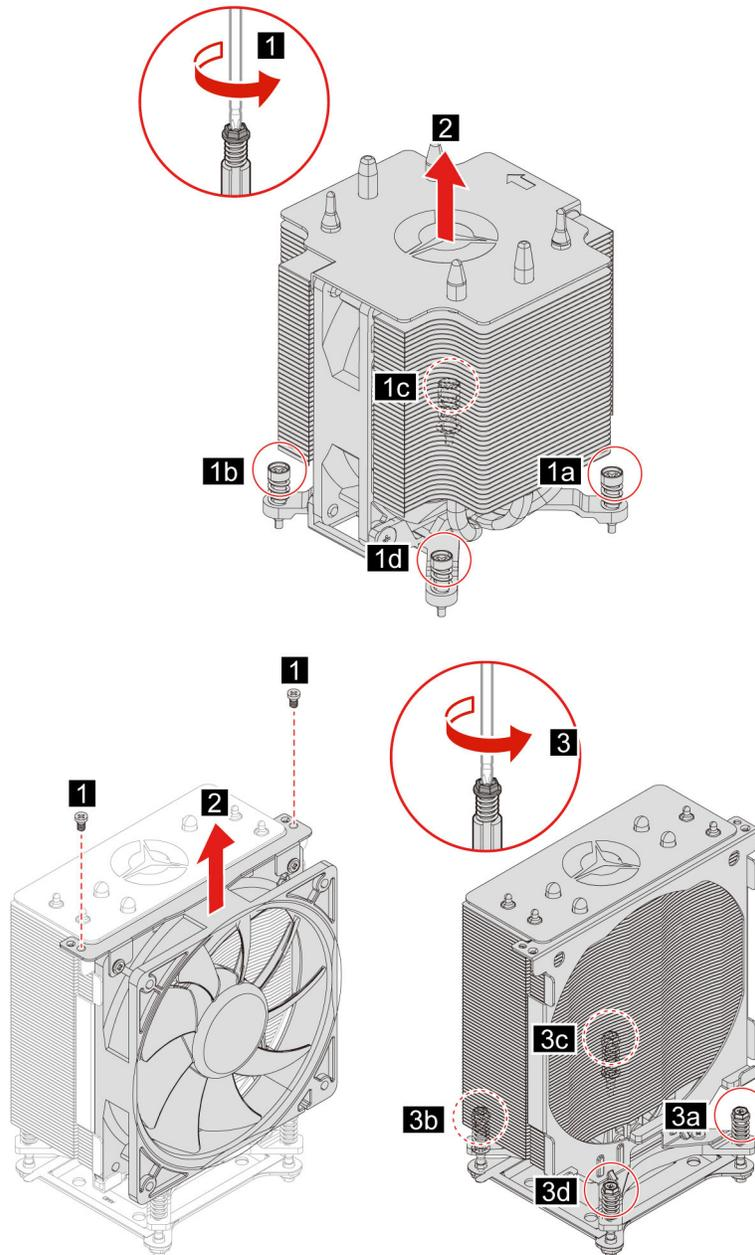
6. Eseguire la procedura di rimozione in senso inverso per reinstallare una nuova CRU.
