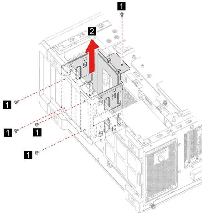
7. Eseguire la procedura di rimozione in senso inverso per reinstallare una nuova CRU.
