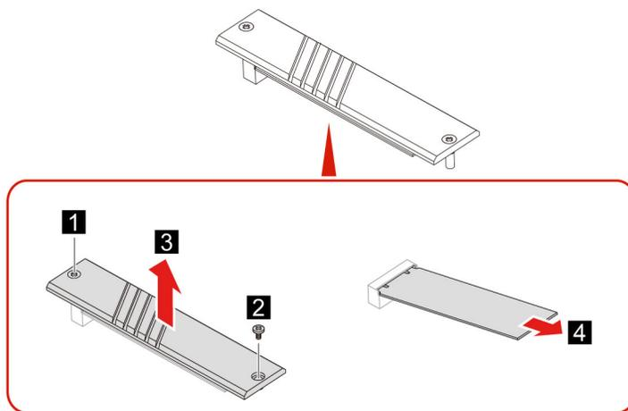
8. Eseguire la procedura di rimozione in senso inverso per reinstallare una nuova CRU.
