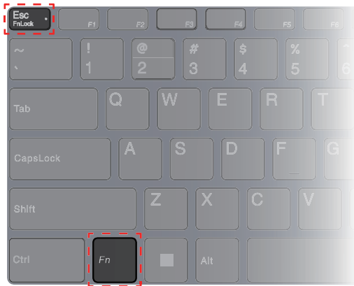
Figura 6. Posizioni dei tasti FnLock e Fn
