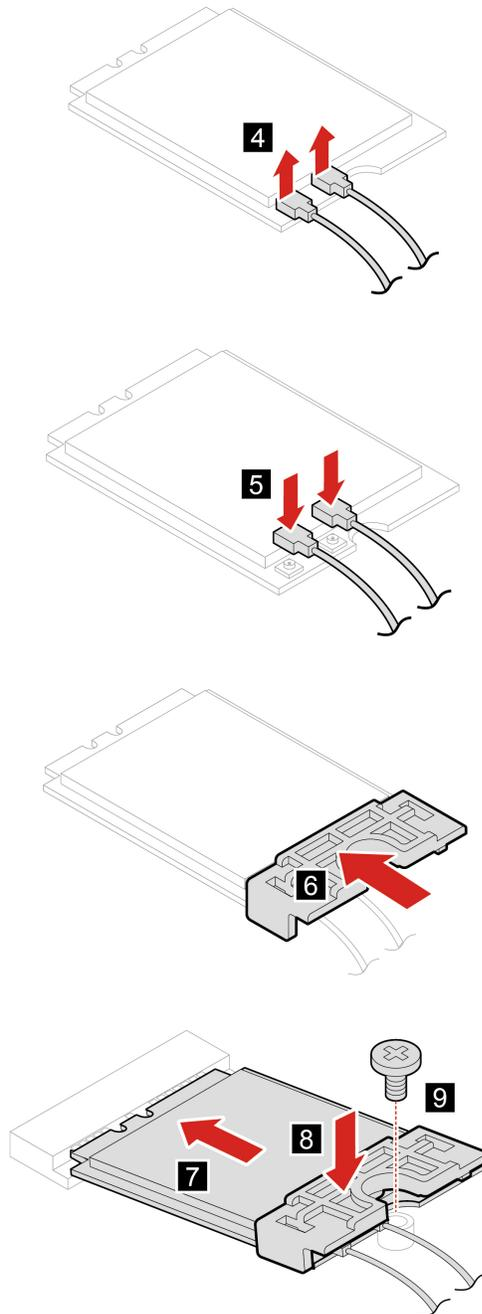
4. Reinstallare i componenti rimossi. Quindi, ricollegare l'adattatore di alimentazione CA e tutti i cavi scollegati al computer.
