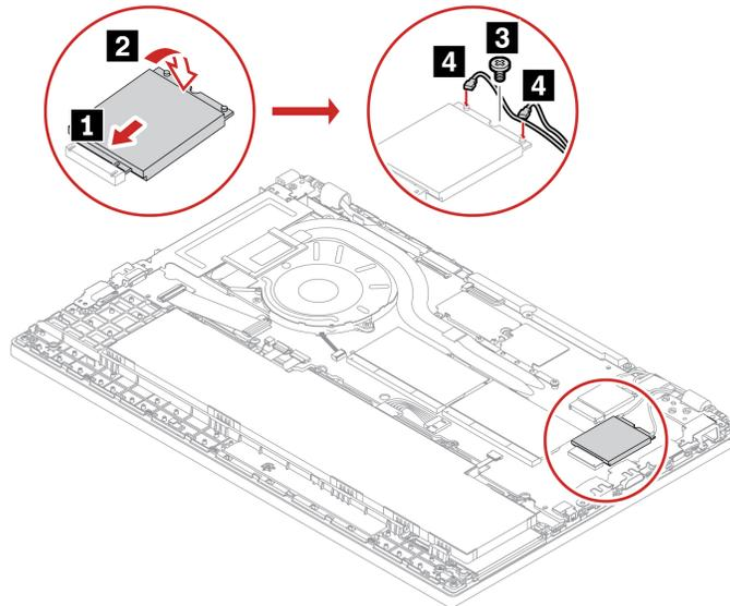
**Nota:** Quando si installa la scheda WWAN, accertarsi di collegare il cavo arancione al connettore principale sulla scheda e il cavo blu al connettore ausiliario sulla scheda.
