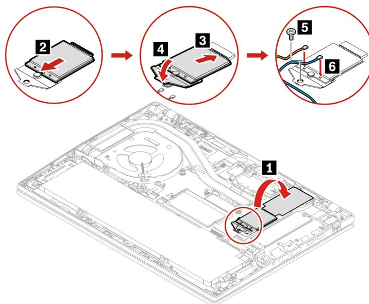
**Nota:** Quando si installa la scheda WWAN, accertarsi di collegare il cavo blu al connettore **AUX** e il cavo arancione al connettore **MAIN**.
