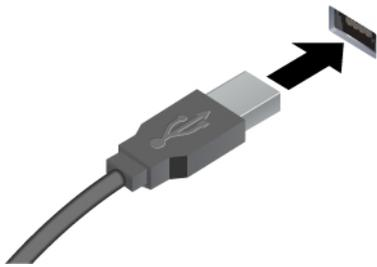
Consente di collegare dispositivi compatibili con USB, come tastiera USB, mouse USB, dispositivo di memorizzazione USB o stampante USB.
