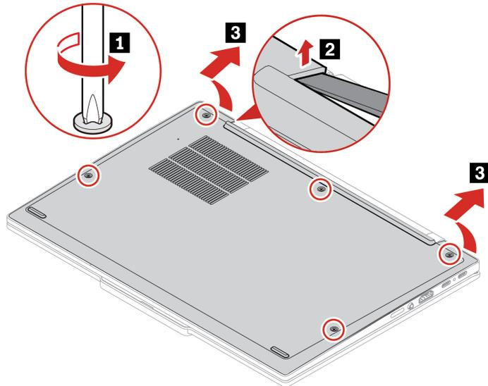
Passo 2. Installare l'assieme del coperchio della base come mostrato di seguito.
