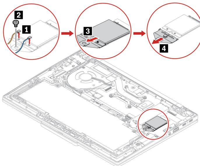
Passo 2. Installare il modulo WWAN e l'apposita staffa in ordine inverso.
