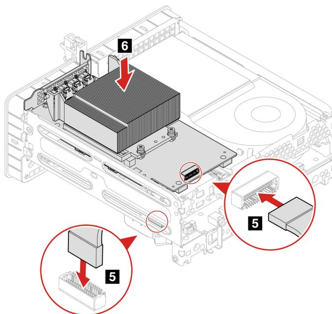
4. Installare il dissipatore di calore MOS sulla scheda PCI-Express e fissare la scheda PCI-Express con le viti.
