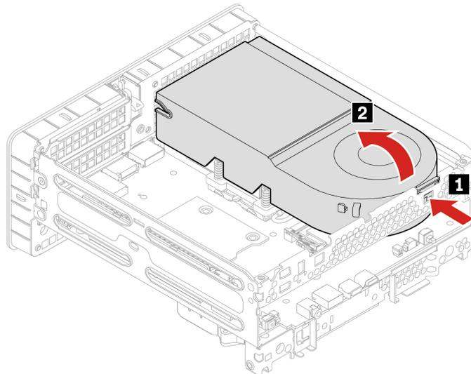
2. Allentare le viti del dissipatore di calore e rimuovere il dissipatore di calore con la ventola di sistema.
