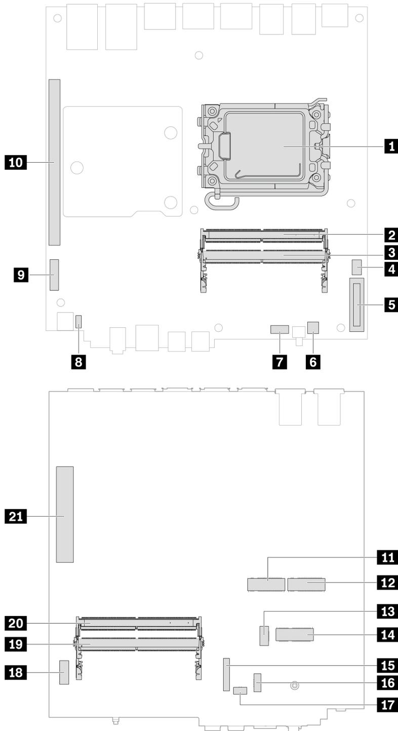
Figura 1. Posizione dei componenti della scheda di sistema
