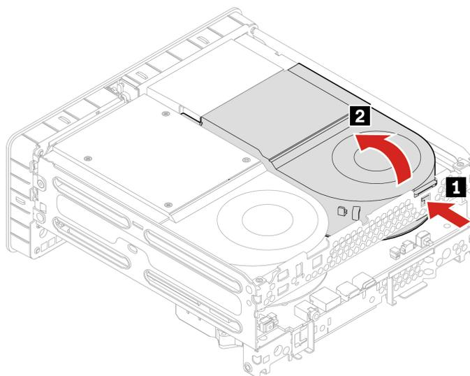
2. Allentare le viti del dissipatore di calore e rimuovere il dissipatore di calore con la ventola di sistema.
