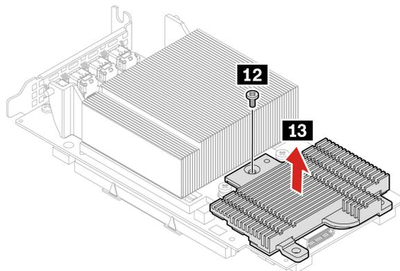
6. Rimuovere il dissipatore di calore termico dalla scheda PCI-Express.
