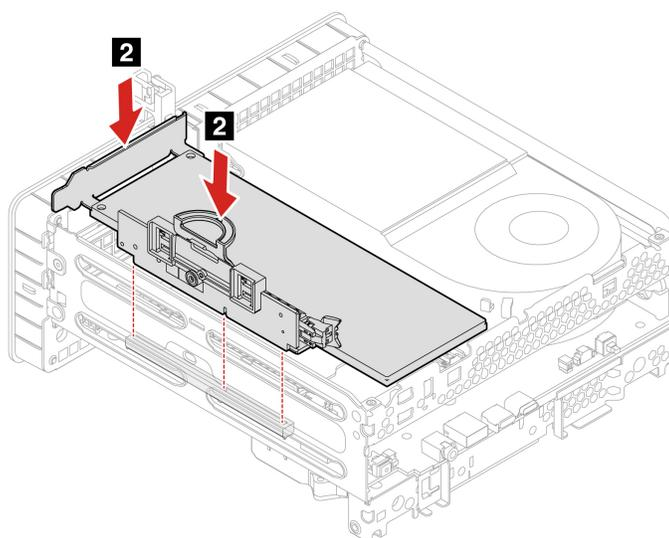
3. Installare la vite per fissare la scheda PCI-Express sul computer e installare la staffa PCI-Express.
