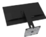
Passaggio 3: rimuovere la base e il supporto dal display, vedere "Rimozione della base del display e del braccio di supporto" alle pagine 2- 8.
