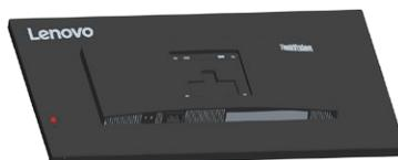
Fase 4: Fissare la staffa di supporto del kit per l'installazione su parete compatibile VESA. (dimensioni 100 mm x 100 mm), usando viti per installazione M4 x 10 mm.
