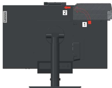
2. Svitare l'antenna Wi-Fi posteriore al connettore dell'antenna sul retro del computer. Quindi, regolare l'angolo dell'antenna a 90 gradi.
