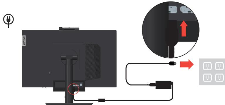
**Nota:** Quando si installa il computer sul monitor TIO per la modalità AIO, assicurarsi di utilizzare l'adattatore di corrente fornito in dotazione al computer quando l'adattatore di corrente del computer è superiore ai 90 W, altrimenti utilizzare l'adattatore di corrente TIO.
