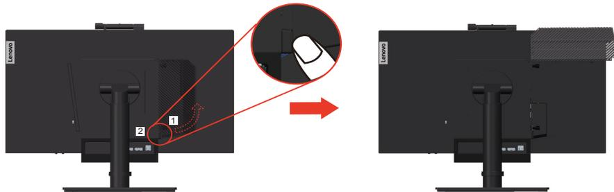
2. Ruotare l'antenna del Wi-Fi posteriore verso il basso a un'angolazione di circa 90°. Quindi, tenere l'estremità più spesso dell'antenna del Wi-Fi posteriore e sviarla dal computer.
