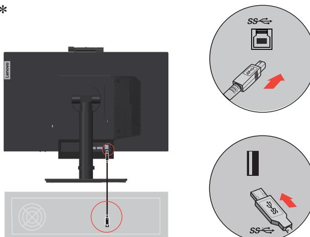
Collegare una estremità del cavo USB al terminale downstream USB sul lato del monitor, e l'altra estremità del cavo USB ad una porta USB appropriata del dispositivo.
