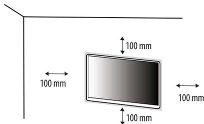
Per installare il monitor su una parete, fissare una staffa per montaggio a parete (opzionale) al retro del monitor. Assicurarsi che la staffa per montaggio a parete sia fissata saldamente al monitor e alla parete.
