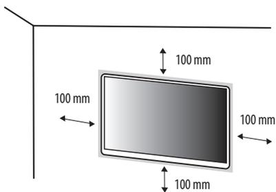
Per installare il monitor su una parete, fissare una staffa per montaggio a parete (opzionale) al retro del monitor. Assicurarsi che la staffa per montaggio a parete sia fissata saldamente al monitor e alla parete.
