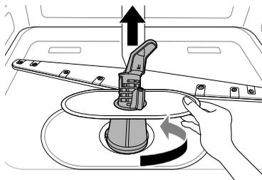
3 Pulire i filtri con una spazzola morbida sotto l'acqua corrente. Rimontare i filtri prima di reinstallarli.
