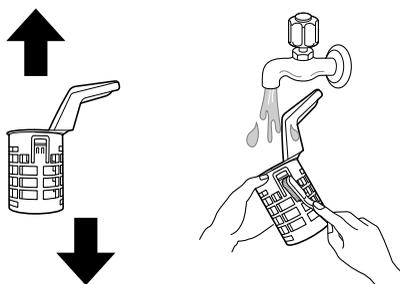
4 Per sostituire un filtro assemblato, posizionare il braccio di spruzzo in modo che l'apertura a V più ampia sia rivolta verso la parte anteriore. Montare nuovamente i filtri nel loro alloggiamento e bloccarli ruotando il filtro
