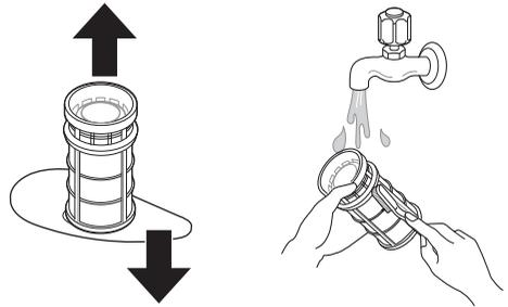
**4** Per sostituire un filtro assemblato, posizionare il braccio di spruzzo in modo che l'apertura a V più ampia sia rivolta verso la parte anteriore. Montare nuovamente i filtri nel loro alloggiamento e bloccarli ruotando il filtro interno in senso orario fino a quando non si avverte un clic ed esso è bloccato in posizione.
