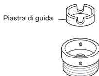
3 Spingere l'adattatore sull'estremità del rubinetto in modo che la guarnizione in gomma formi un collegamento stagno. Stringere le quattro viti di fissaggio.
