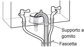
Reinstallare il tubo di scarico.
