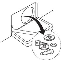
4 Dopo la pulizia, ruotare il filtro della pompa e inserire il tappo di scarico.
