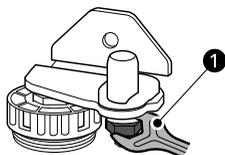
2 Utilizzare la chiave ❷ per regolare l'altezza ruotando il perno della cerniera di regolazione a sinistra o a destra.
