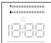
Barra dell'efficienza energetica/idrica è un indicatore di efficienza composto da 2 barre. La barra dell'efficienza energetica/idrica mostra la quantità di energia e il consumo di acqua. Più grande è la barra, maggiore sarà il consumo di energia o acqua. La barra dell'efficienza energetica/idrica potrebbe allungarsi o ridursi a seconda della durata del programma selezionato, dell'impostazione della temperatura, della velocità di centrifuga e di altre funzioni ausiliarie.
