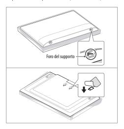
La distanza della vite dalla superficie esterna del pannello posteriore deve essere inferiore a 8 mm. (Solo 24/28LN66\*)
