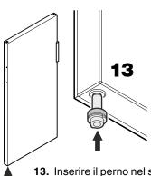
13. Inserire il perno nel supporto sinistro dello sportello. Durante il montaggio dello sportello tenere il perno con l'indice.
