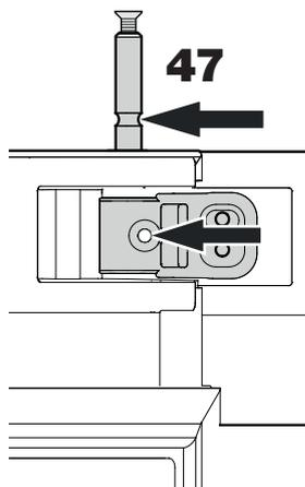
47. Inserire il perno finché la scanalatura del perno non è allineata con il foro del cantonale cerniera.
