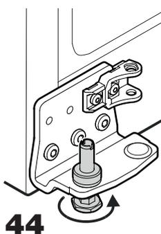
44. Inserire completamente il perno nel cantonale cerniera e serrare manualmente il piedino regolabile.
