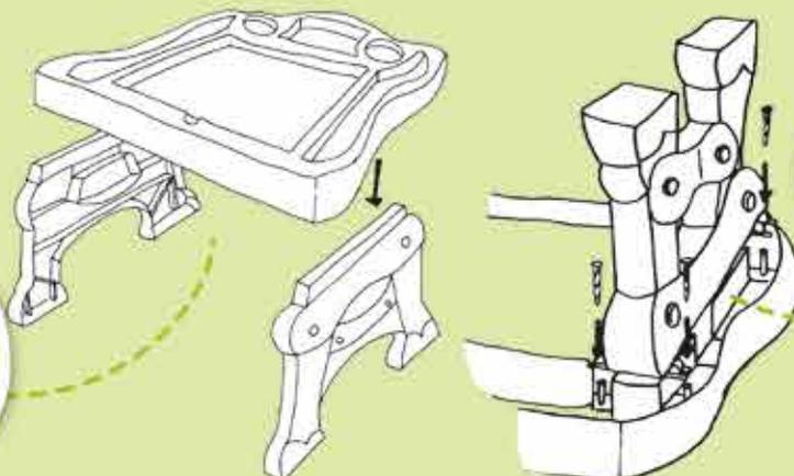
Avvitare le spalle negli appositi spazi con le viti in dotazione (4 per ogni spalla).
