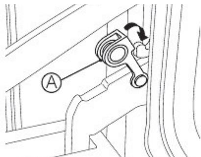
Per modelli B, inserire negli appositi fori un perno blocca movimento di rotazione. Afferrare la porta ai lati e chiuderla lentamente finché si avverte una certa resistenza, a questo punto forzare e contemporaneamente alzare la porta verso l'alto in modo da liberare l'incastro della cerniera dal corpo della cucina e sfilarla.
