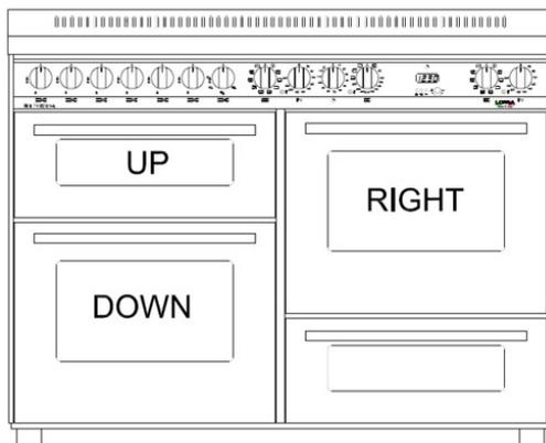
Le cucine dimensioni 90x60 a tre forni hanno a disposizione 1 forno da 60 litri e 2 forni da 30 litri con resistenze elettriche.
