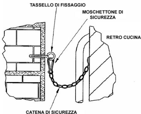
Per l'installazione ancorare il fornello utilizzando il kit fornito riferendosi al disegno sottostante. Vengono fornite due staffe, che serviranno per ancorare la spalletta della cucina, seguendo le istruzioni dei disegni successivi. N.B. In caso di cucina senza spalletta si deve sollevarla leggermente per far entrare la staffa sull'orlo del piano.
