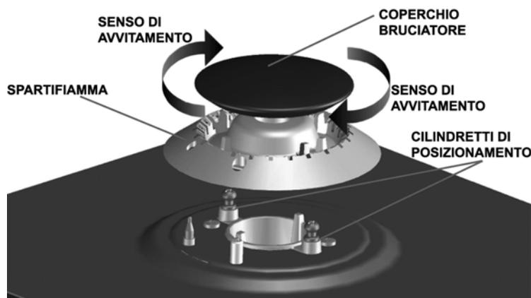
delle viti dei due cilindretti dello spartifiamma sottostante ed avvitato in senso orario (come indicato in figura).
