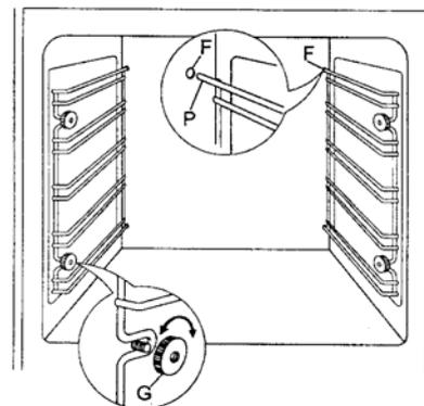
già predisposte sulle fiancate, fissare le guide con i dadi/ghiera G. Non lavare il forno quando è ancora caldo e non adoperare sostanze o prodotti abrasivi.
