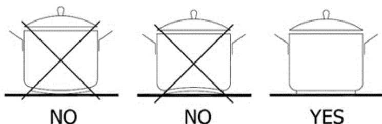
Ogni piastra è dotata di un dispositivo "presenza pentola", che assicura l'inizio del funzionamento solo in presenza di una pentola adatta nella zona di cottura e correttamente posizionata. In caso di pentola non adatta o mal posizionata il piano non viene attivato e compare U
