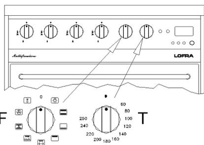
Le cucine multifunzione sono caratterizzate dal fatto che il calore, nel forno, può propagarsi sia in modo naturale (convezione), che forzato (motoventilatore).
