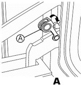
Aprire totalmente la porta del forno, inserire il dispositivo blocca movimento di rotazione (A) sull'apposito gancetto delle staffe delle cerniere. Afferrare la porta ai lati e chiuderla lentamente finché si avverte una certa resistenza, a questo punto forzare e contemporaneamente alzare la porta verso l'alto in modo da liberare l'incastro della cerniera dal corpo della cucina e sfilarla.
