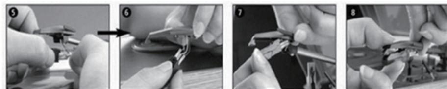
Sostituire con una nuova puntina, assicurarsi che i cavi audio siano montati saldamente e quindi agganciarli nuovamente al braccio del giradischi.
