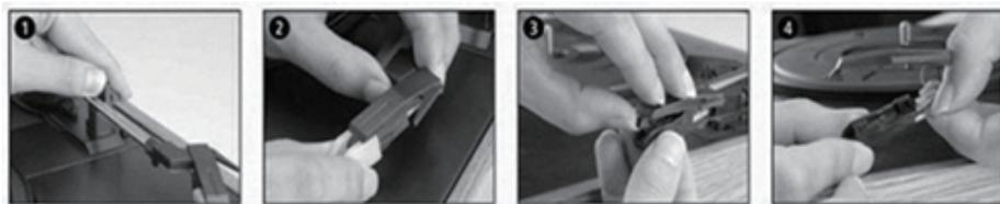
Sollevare la leva blocco braccio giradischi per rilasciarlo, rimuovere la protezione dalla testina per sostituire la puntina
