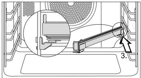
■ Spingere la guida FlexiClip lungo il sostegno superiore verso il retro fino alla battuta d'arresto (3.).
