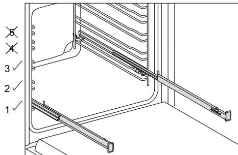
Le guide completamente estraibili FlexiClip possono essere montate solo sui ripiani 1, 2 e 3.
