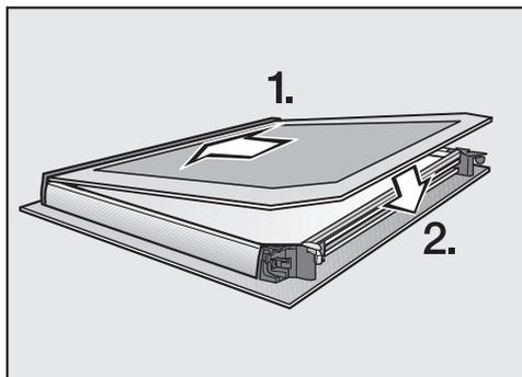
■ Inserire la lastra interna dello sportello con il lato opaco rivolto verso il basso nel listello in plastica e sistemare la lastra interna dello sportello tra i dispositivi di blocco.
