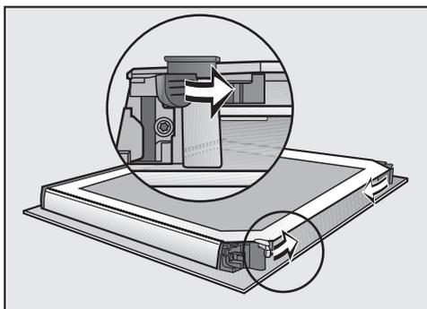
■ Chiudere i dispositivi di blocco delle lastre di vetro ruotandoli verso l'interno.
