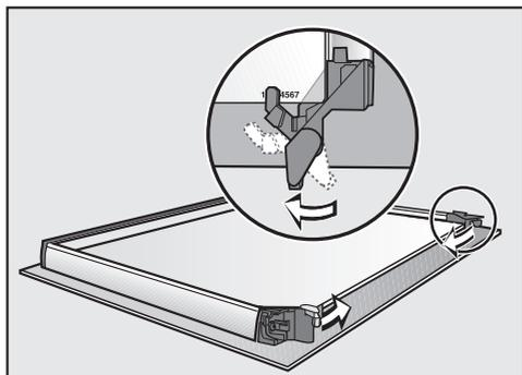
■ Ruotare verso l'interno i dispositivi di blocco in modo che poggino sulla lastra inferiore delle due centrali.
