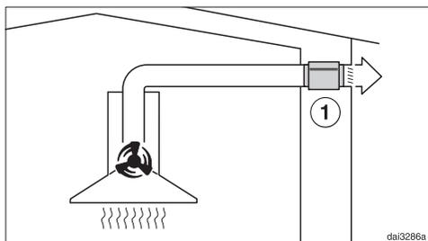
Il silenziatore attutisce i rumori dell'aspiratore verso l'esterno e anche i rumori che dall'esterno penetrano in cucina attraverso il canale di scarico dell'aria (ad es. i rumori del traffico). Posizionare il silenziatore il più vicino possibile al bocchettone uscita aria ①.
