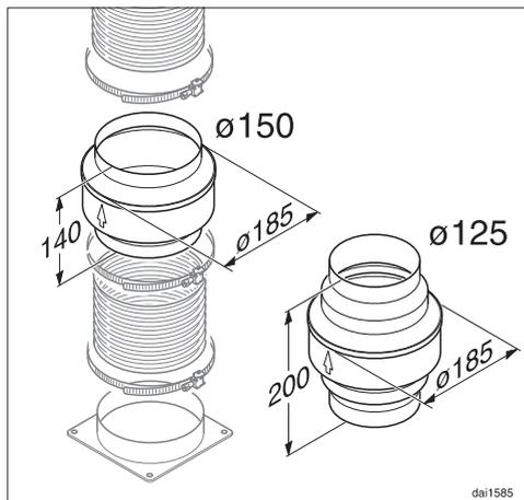
Oltre a isolare il condotto, si consiglia di installare un dispositivo che raccolga e faccia evaporare l'acqua di condensa. Tale dispositivo è disponibile sia per tubi con diametro da 125 mm che da 150 mm.
