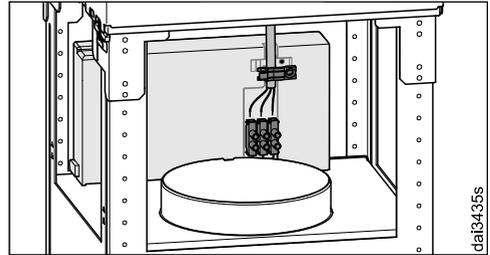
Per un allacciamento a regola d'arte utilizzare il dispositivo fermacavo in dotazione.
