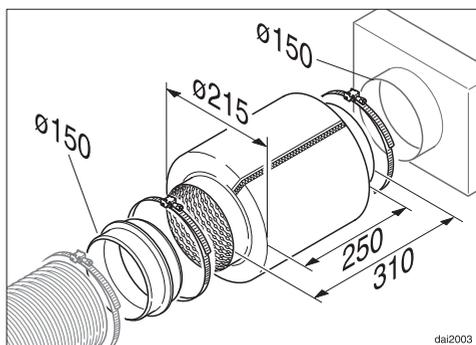
È possibile montare un silenziatore nella conduittura di scarico dell'aria che serve a ridurre il rumore.
