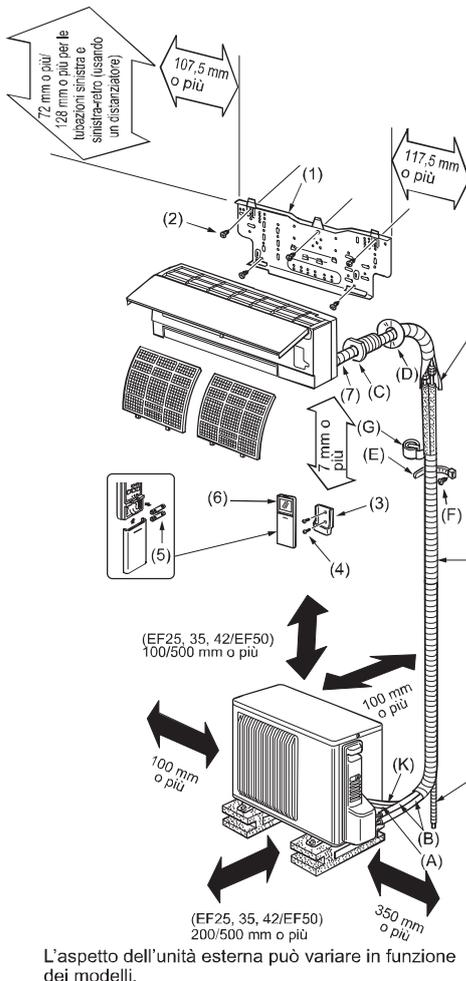
Avere cura di utilizzare la manica foro muro (C) per impedire il contatto tra il cavo di collegamento interno ed esterno (A) e le parti metalliche nel muro, nonché per prevenire danni causati da roditori nel caso in cui il muro sia cavo.
