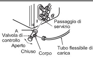
Al momento del fissaggio della valvola di controllo al passaggio di servizio, lo spillo della valvola può deformarsi o allentarsi nel caso venga esercitata una pressione eccessiva. Ciò può causare perdite di gas.
