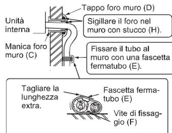
Dopo aver verificato l'assenza di perdite, applicare il materiale isolante facendolo aderire bene, in modo da non lasciare aperture.
