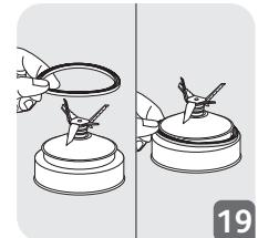
• После этого не забудьте правильно установить уплотнитель (**F3, O3**) на блок лезвий (**F1, O1**) (Рис. 17). Во избежание повреждения уплотнителя следите за тем, чтобы он не касался лезвий.
